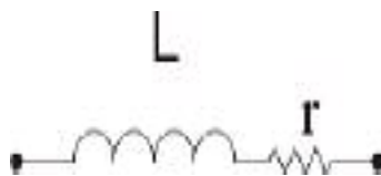
Figura 13- Schema echivalentă a unei bobine reale
