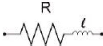
Figura 12- Schema echivalentă a unui rezistor real
