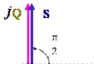
Figura 6 - Diagrama fazorială a puterilor absorbite de o inductanță
