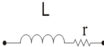
Figura 13 – Esquema equivalente de uma bobine real
