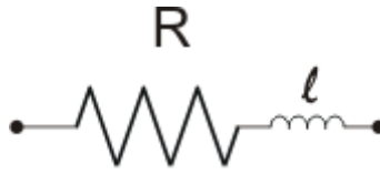
Figura 12 – Esquema equivalente de resistência real
